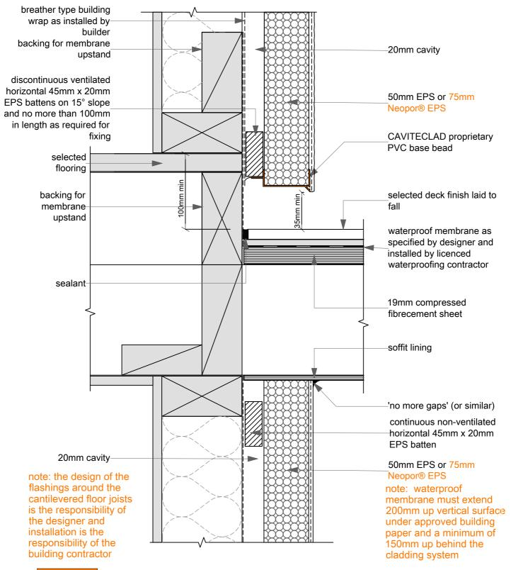
Wall / Floor: CANTILEVERED JOISTS
