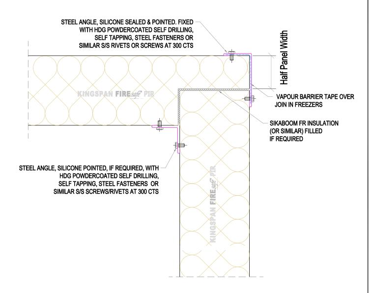
(W) TYPICAL REBATED EXTERNAL COLDSTORE CORNER JOINT DETAIL
