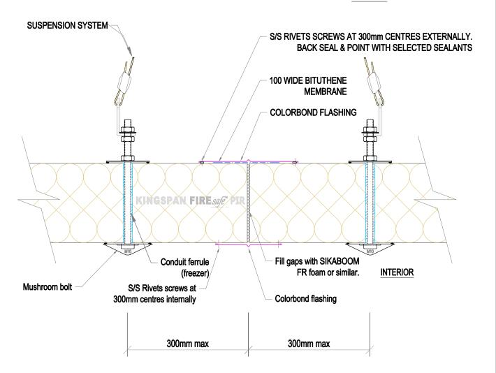
(P) TYPICAL SUSPENDED CEILING SUPPORT (FREEZER)
