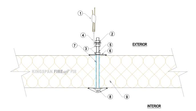
(S & Z) TYPICAL SUSPENDED CEILING INTERMEDIATE SUPPORT (FREEZER)
