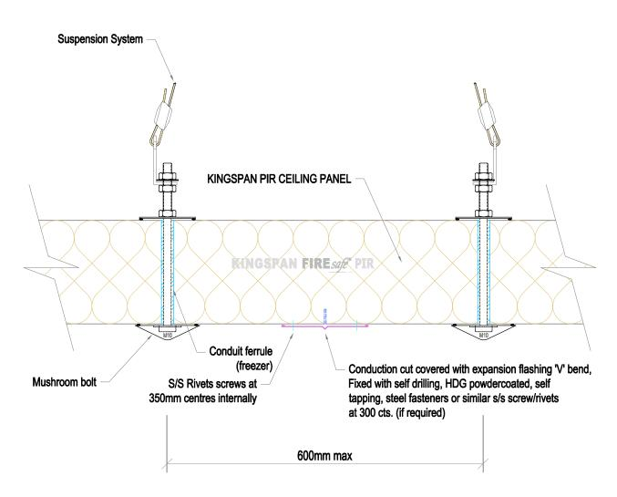
(O) TYPICAL SUSPENDED CEILING SUPPORT (FREEZER CONDUCTION CUT)
